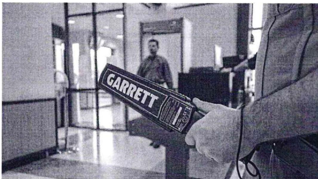
Типовые характеристики ручных металлодетекторов: расстояние обнаружения металлического предмета: среднего размера пистолет — 20-25 см; бритвенное лезвие — 8-10 см; большой карманный нож — 15-20 см; булавка — 2-3 см.
